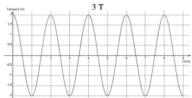
1.3. L'expérimentateur a juste changé le volume : en effet, on constate que l'amplitude de la tension 2 est supérieure à celle de la tension 1, par contre sa période et sa forme n'ont pas changé : on en déduit que **l'intensité sonore est plus élevée**.
